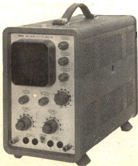
Esempio di nuovo oscilloscopio (GM 5606) per impieghi industriali di bassa frequenza e ultrasuoni. Sensibilità Y : 10 mV/div : Sensibilità X : 30 mV/div.
