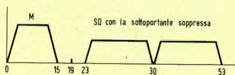
Fig. 6 - Spettro del segnale « audio » stereo dove è stata soppressa la sottoportante.
