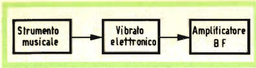
Fig. 2 - Schema a blocchi del vibrato elettronico.
